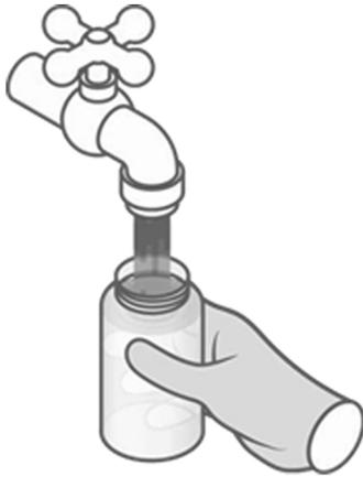
**Después de 30 segundos**, mientras fluye el agua, coloque la botella para muestra debajo de la tubería y llénela hasta el hombro o hasta la línea con la leyenda "250 ml". Cierre bien la tapa.
